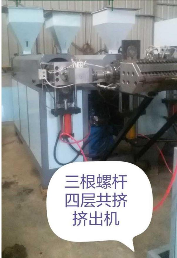
EXTRUSORA DE 3 TORNILLOS Y 4 LAMINADOS EN 1
